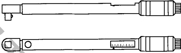
图 B.1 A 型:带刻度可调型扭力扳手
